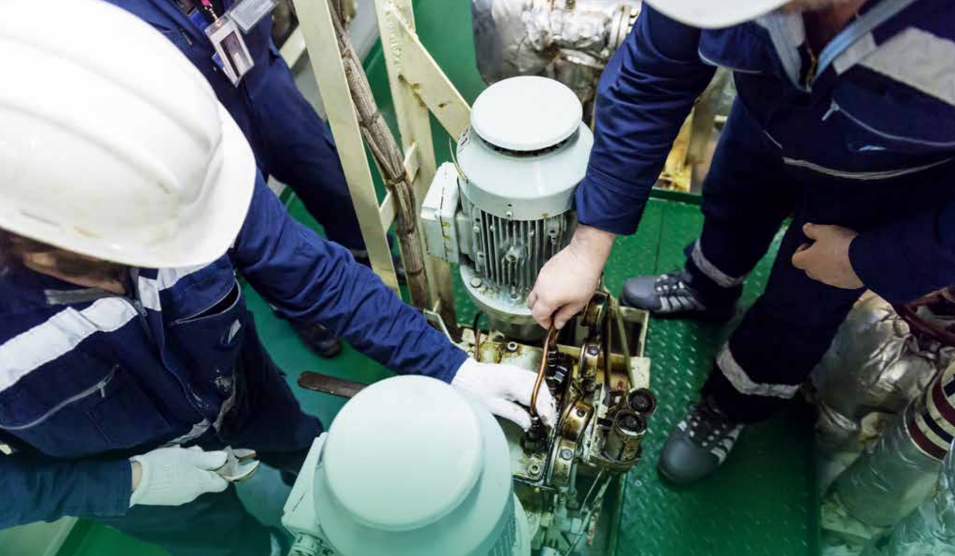
INSPEKSJONSTEAMET tar prøver av drivstoffet på et lasteskip for å teste svovelinnholdet.
