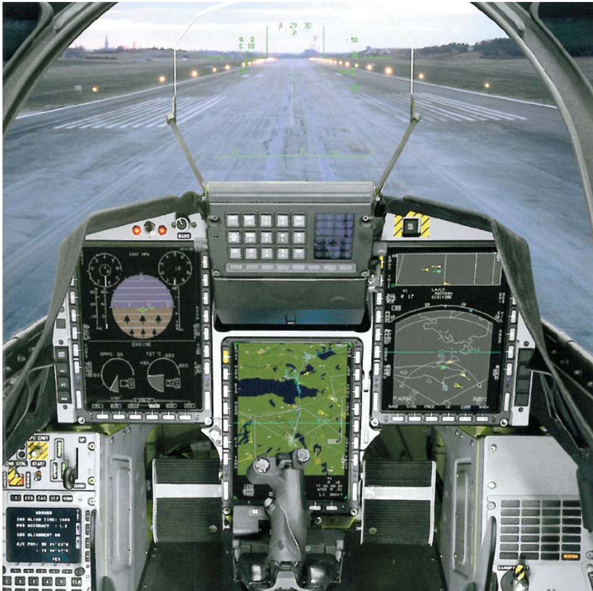
Fig. 2. Cockpiten på et svensk Jas-39 Gripen. Kartet midt på instrumentpanelet er orientert med kursen opp. I dette tilfellet står flyet på Linköping lufthavn med nesen vendt mot vest. I den øvre halvdel av kartet ser vi innsjøen Vättern.
