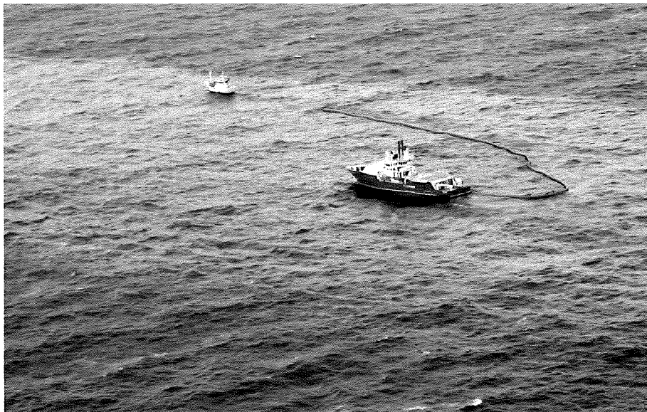
Fig. 1: Bilde av et NOFO system i operasjon. OR fartøy og fiskebåt som slepefartøy
