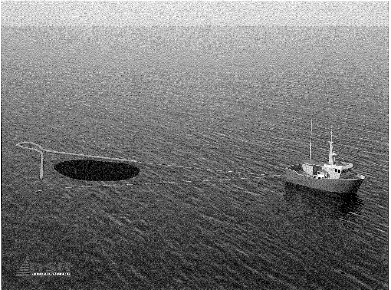
Fig. 31: Figur viser fartøy og Bustersystem sett ovenfra (en-båtssystem).
