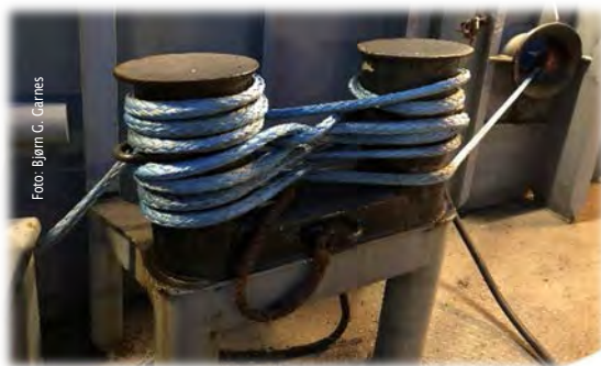
Puller med styrkebegrensninger, ikke egnet for slep
